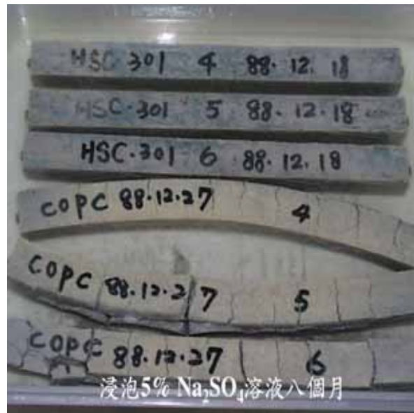
水泥與HSC301比較(浸泡5% Na 2 SO 4 溶液8個月)
